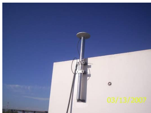
Mástil anclado al tabique de una pared de la Universidad de San Juan.
