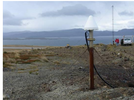
Mástil empotrado en roca en el aeropuerto internacional de Ushuaia, Tierra del Fuego.
