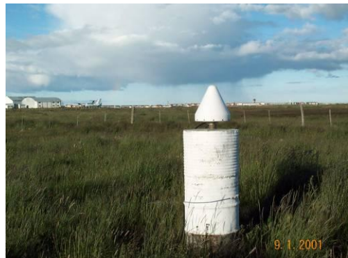
Pilar construido sobre terreno sedimentario en las proximidades de Río Grande, Tierra del Fuego.
